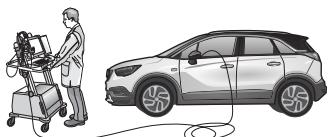
Die Beleuchtungsfunktionen am Anhänger funktionieren nur NACH Konfiguration des Fahrzeuges auf Anhängerbetrieb!
